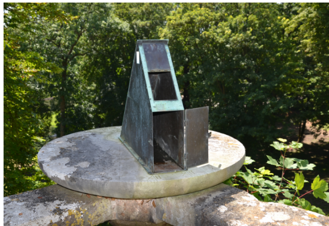
Fig 1 : Le cadran solaire horizontal du château de la Roche Guyon avec sa chambre méridienne. On a ouvert les deux portes d'accès côté Nord.
