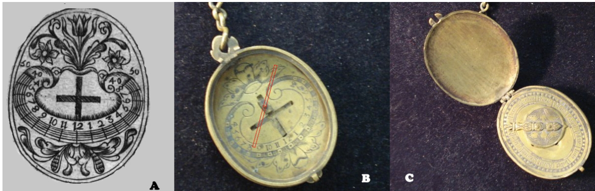
Fig. 17 : A ; Copie d'une illustration originale de Georges (1660) de la face supérieure de son cadran (l'aiguille aimantée et son pivot mobile ne sont pas représentés). B & C : faces supérieure et inférieure du cadran du British Museum. La position de l'aiguille aimantée est ajoutée en rouge. Le pivot de cette aiguille peut translater dans la fente parallèle à l'axe des 12 heures, sous l'effet du réglage de la molette excentrique de la face inférieure en fonction de la date du calendrier. Le couvercle supérieur ayant été perdu, on ne peut pas juger s'il contenait le système de visée (« directoire ») qui, dans la description de Georges, permet de compenser la déclinaison magnétique
