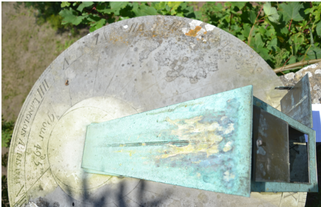
Fig 3 : Sur cette photo, on voit nettement la fente polaire qui laisse entrer les rayons solaires. Notons également la signature gravée de Langlois en bas du cadran.
