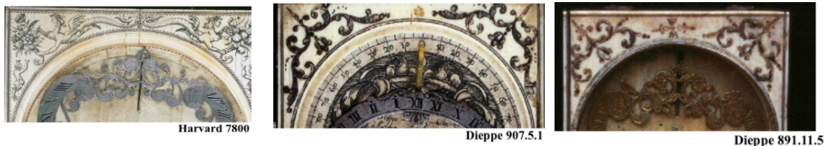
Fig. 8: Cadrans azimuthaux magnétiques avec correction de la déclinaison magnétique (on remarque le décalage du Nord avec le plan de symétrie du cadran, d'environ 5°, à comparer avec les photos de l'Annexe 3). Cette particularité a déjà été signalée, et interprétée, sur le diptyque n°7800 de Harvard par Lloyd (1992).
