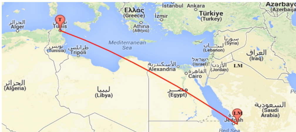
Fig. 1 : Trace du grand cercle passant par Tunis et La Mecque sur une représentation plane de la surface terrestre (projection Mercator). Ce trait courbe sur la carte représente, sur la surface terrestre, le chemin le plus court entre les deux points.
